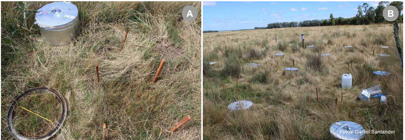
Figura 2 - Instalaciones de las bases de las cámaras y parcelas en campo natural para mediciones de emisiones y evolución de nitrógeno mineral en suelo después de aplicación de orina.
