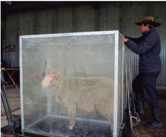
**Figura 4.** Imagen de un animal dentro de la cámara de acumulación portátil, para la estimación de la emisión de metano. (Foto: Alessandro Zuchetti).
